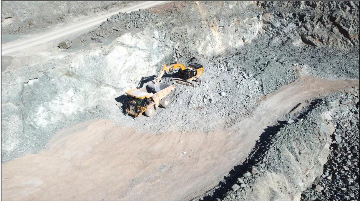
**Figure 7 - Extraction du matériau en fond d'excavation**
